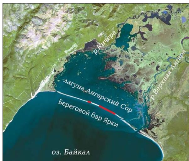
Устьевая область р.Верхняя Ангара в 1974 (слева) и 2013 гг. Красными линиями показаны промоины, образовавшиеся в теле берегового бара Ярки.
